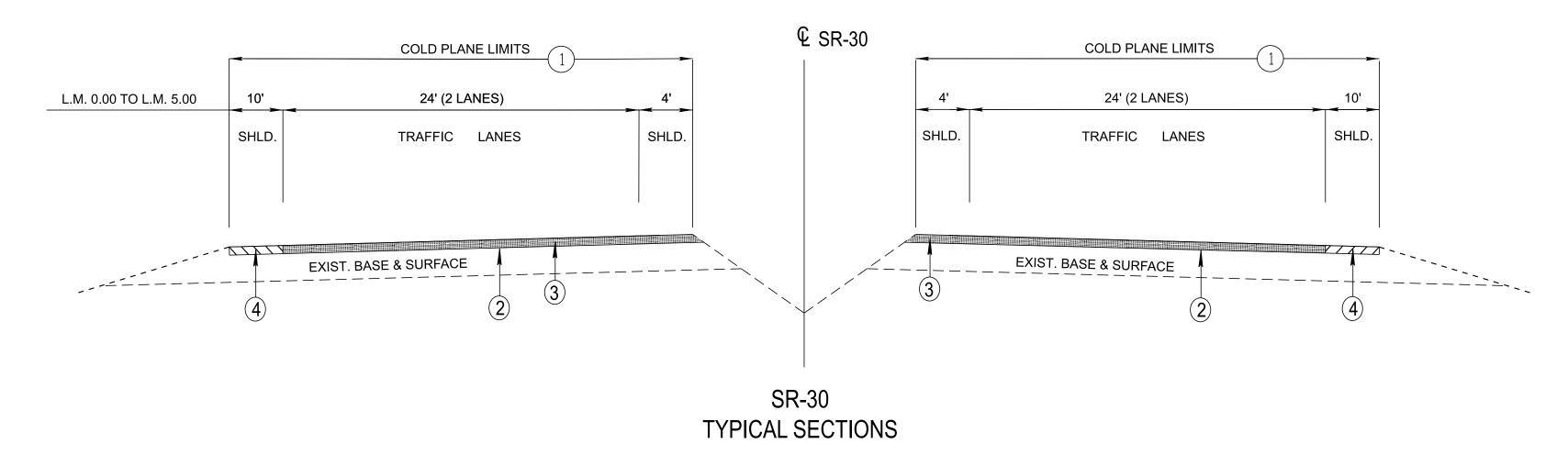
LONGITUDINAL JOINT SEALANT (ITEM 411-01.21) SHALL BE USED ON LANE JOINTS.
